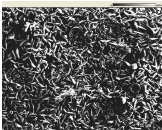
Figura 27: superfície fosfatizada, enxágue com neutralizante, exposição à atmosfera úmida saturada por 72h. a) seleção dos pontos para análise EDS; b) análise EDS do ponto 1; c) análise EDS do ponto 2; d) aspecto da camada fosfatizada; e) morfologia dos cristais e heterogeneidades na camada.
