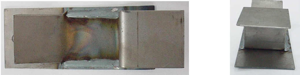
Figura 12: Corpo de prova com solda lateral (fresta com duas extremidades livres)
