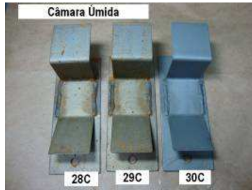
Figura 34: corpos de prova com solda lateral submetidos a ensaio acelerado em atmosfera úmida saturada: a) enxágue com neutralizante e b) enxágue com água
