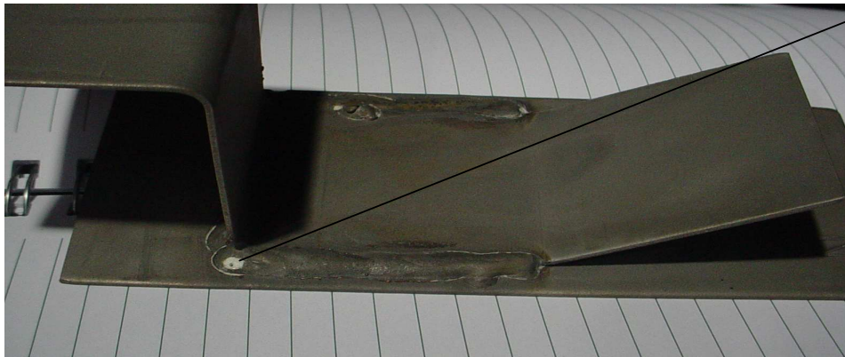
Figura 19: corpo de prova com solda em “U”, enxágue com neutralizante, com porosidade na solda e presença de resíduos de prétratamento
