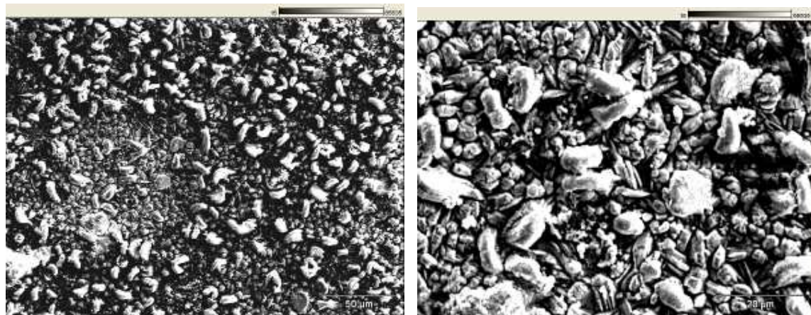
Figura 28: superfície fosfatizada, , enxágue com água, exposição à atmosfera úmida saturada por 72h. a) seleção dos pontos para análise EDS; b) análise EDS do ponto 1; c) análise EDS do ponto 2; d) aspecto da camada depositada; e) morfologia dos cristais e heterogeneidades na camada.
