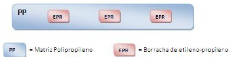
Figura 6: Representação da estrutura molecular do PP copolímero heterofásico.
