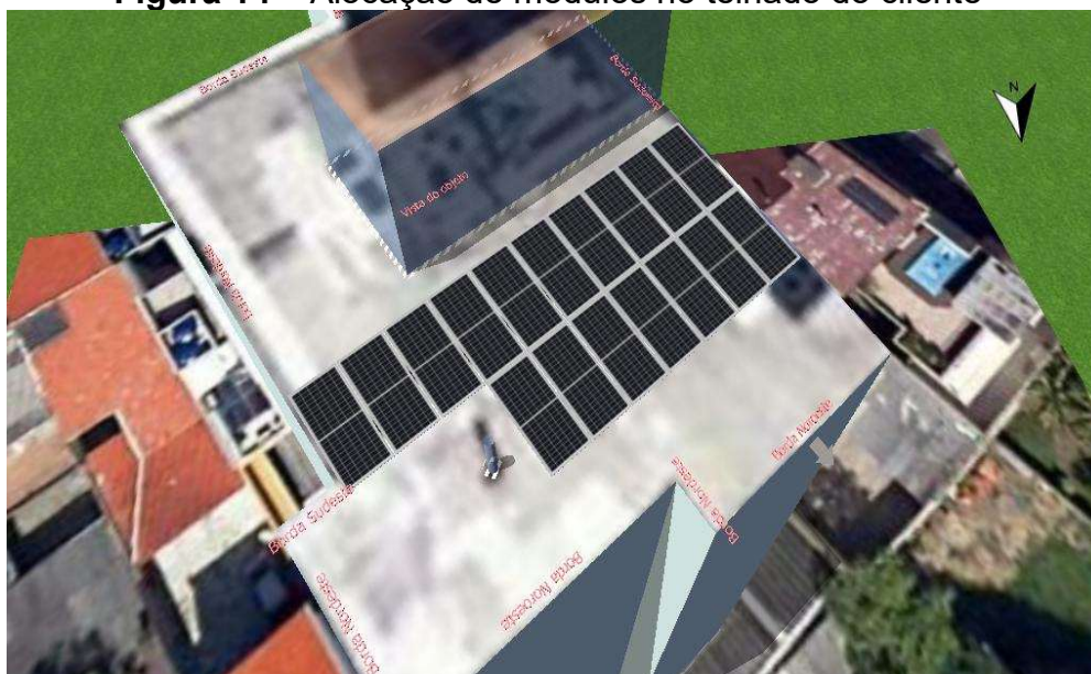
Figura 14 – Alocação de módulos no telhado do cliente
