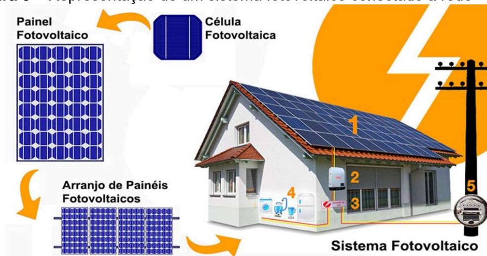
Figura 8 – Representação de um sistema fotovoltaico conectado à rede
