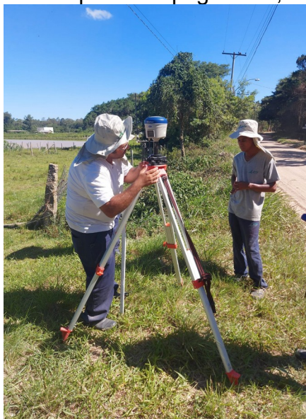
Figura 7 - Levantamento de pontos topográficos, no KM 73 da ERS-118.
