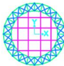
Figura 15 - Vista superior do modelo estrutural do anel de torção e estrutura de sustentação dos equipamentos sobre a cobertura
