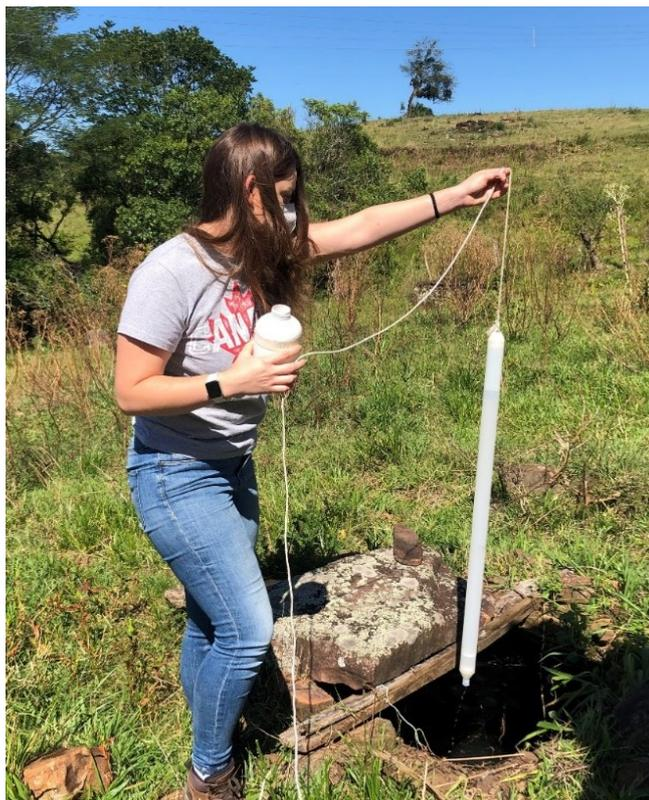
*Figura 10. Coleta de amostra de água de poço cacimba para posterior análise química em laboratório.*
