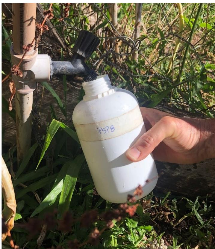
*Figura 11. Coleta de amostra de água para posterior análise química em laboratório.*
