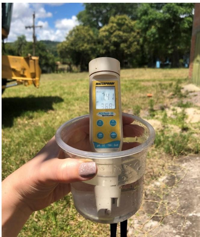
Figura 9. Análise de amostra de água em campo utilizando a sonda multiparâmetros modelo Eutech PCTestr 35.
