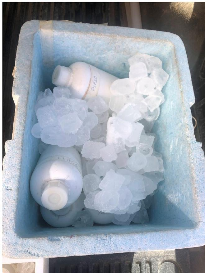
*Figura 12. Armazenamento das amostras em isopor com gelo.*
