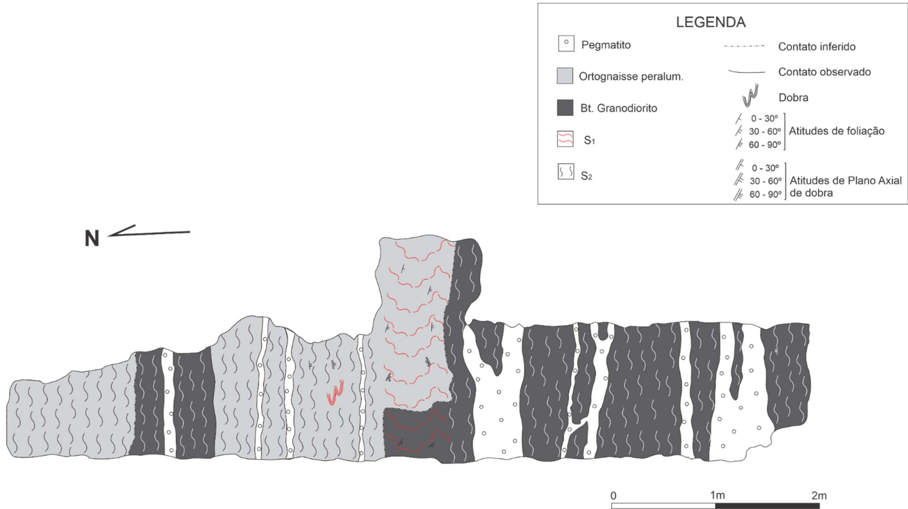
Figura 14 - Croqui esquemático de uma porção do afloramento ST05, mostrando as foliações S 1 e S 2a , com a presença do biotita granodiorito porfírico, além do ortognaisse peraluminoso e alguns veios de pegmatito.
