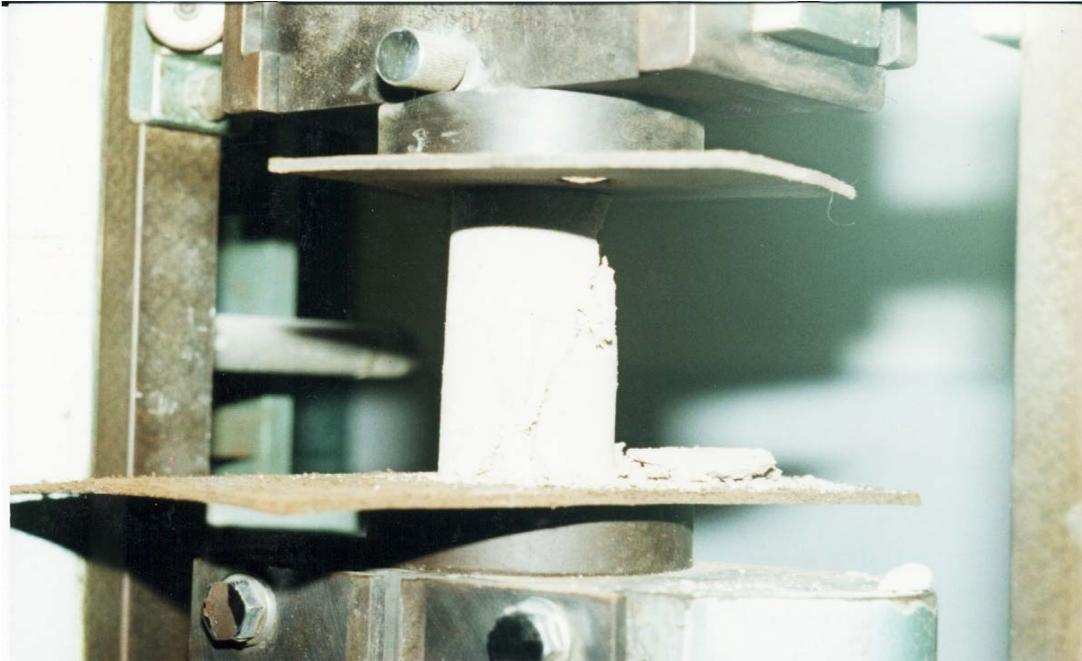
FIGURA 3.6 – Forma de ruptura dos corpos-de-prova submetidos a compressão axial
