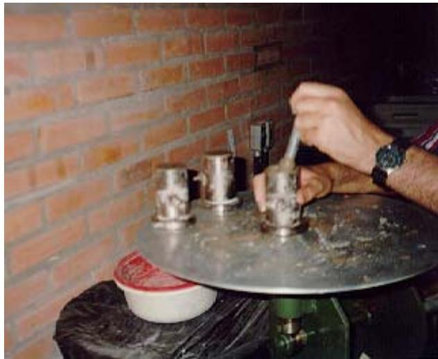
FIGURA 3.3 - Moldagem dos corpos-de-prova
