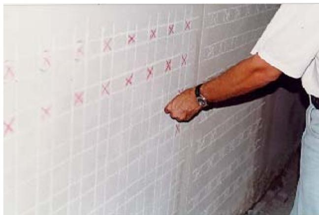
FIGURA 3.11 – Demarcação das seções dos corpos-de-prova a serem ensaiados
