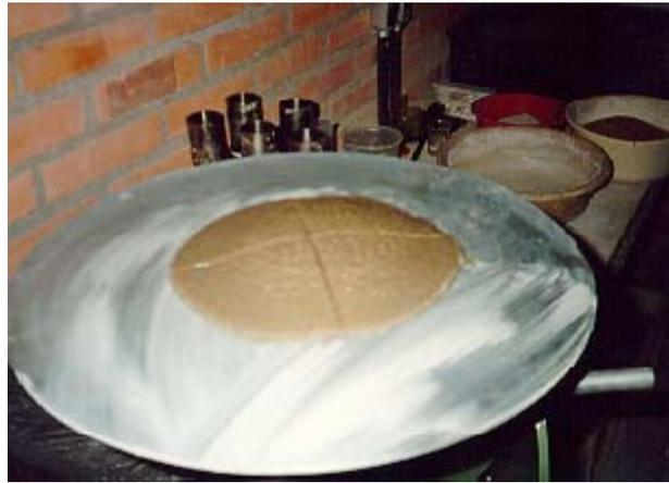
FIGURA 3.4 – Ensaio de consistência
