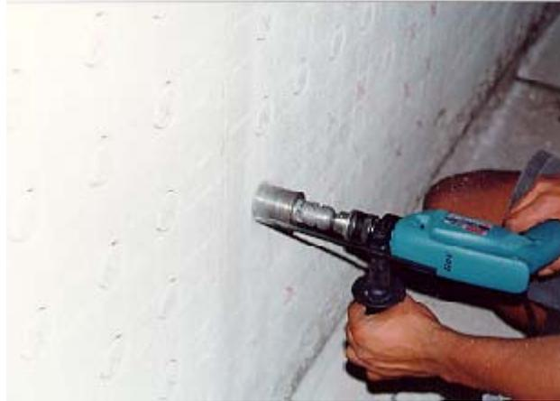
FIGURA 3.12 – Execução dos cortes para obtenção dos corpos-de-prova
