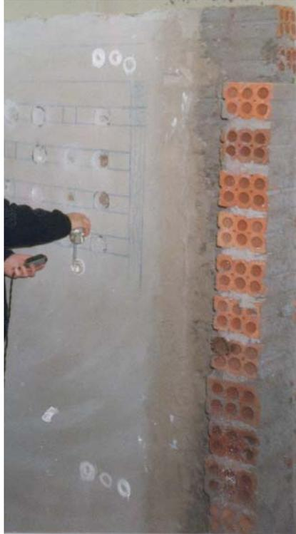
FIGURA 3.18 – Execução do ensaio de absorção de água
