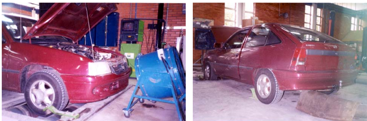
Figura 9.1- Veículo Kadett no dinamômetro do Laboratório de Motores da Petrobras
