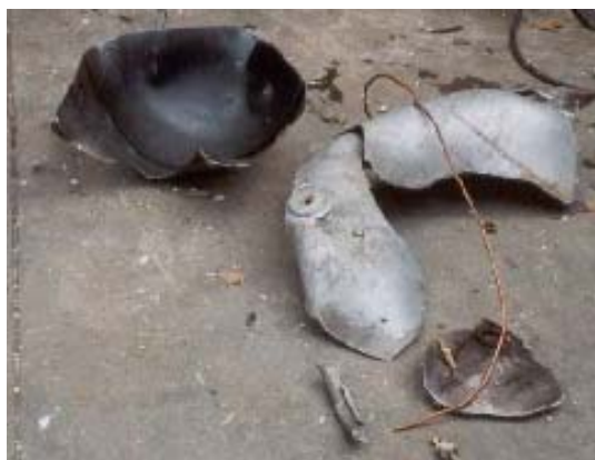
Figura 14.8 - Botijão de GLP após explosão devido ao uso de GNV em alta pressão
