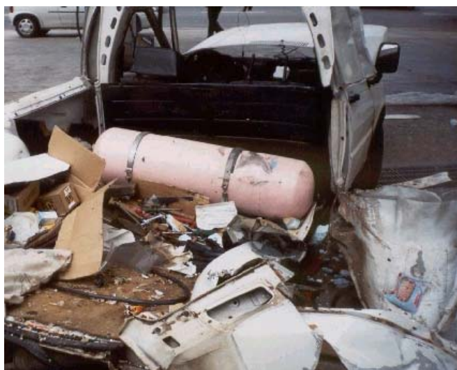
Figura 14.9 - Cilindro de armazenamento de GNV intacto após explosão do botijão
