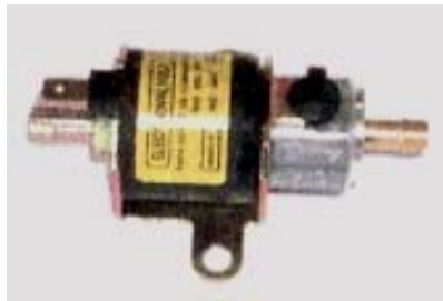
Figura 7.11 – Válvula de corte de combustível líquido
