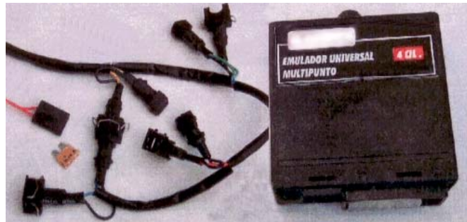
Figura 7.13 - Emulador de eletro-injetores (bicos injetores)
