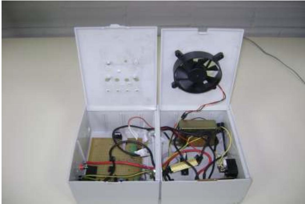
Figura 5.4.1 Módulo de Potência da Jiga de Testes.
