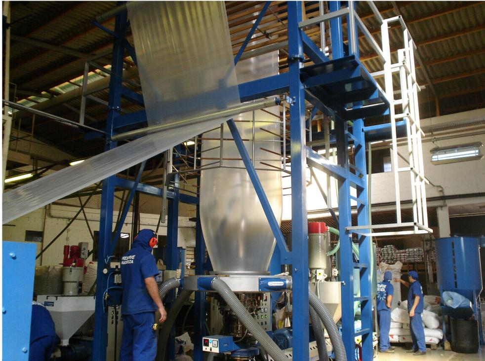
**Figura 2 – Instalações Azeplast – Processo de Extrusão**
