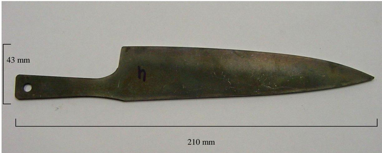
Figura 3.1 – Imagem da lâmina escolhida para os ensaios, Aço AISI 420 após a têmpera.
