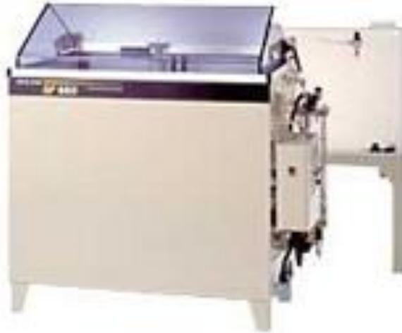
Figura 2.5 – Máquina de ensaios de corrosão
