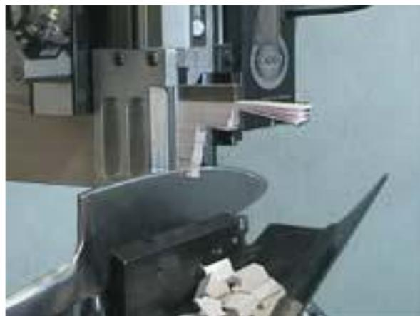
Figura 2.4 – Máquina de ensaio de Desgaste
