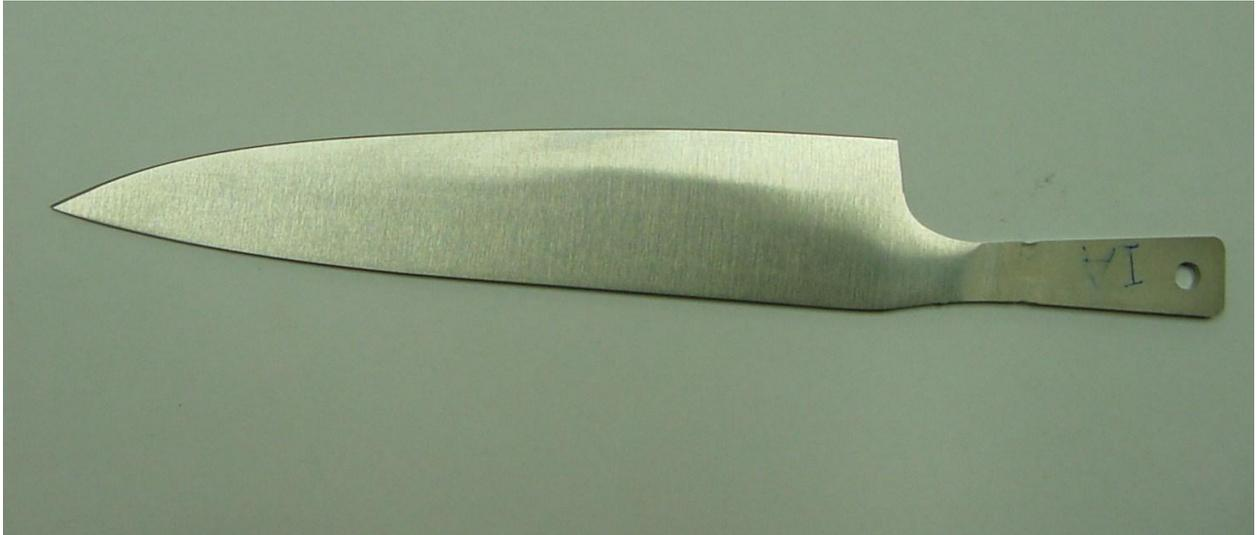
Figura 3.2 – Perfil da faca após desbaste e afiação
