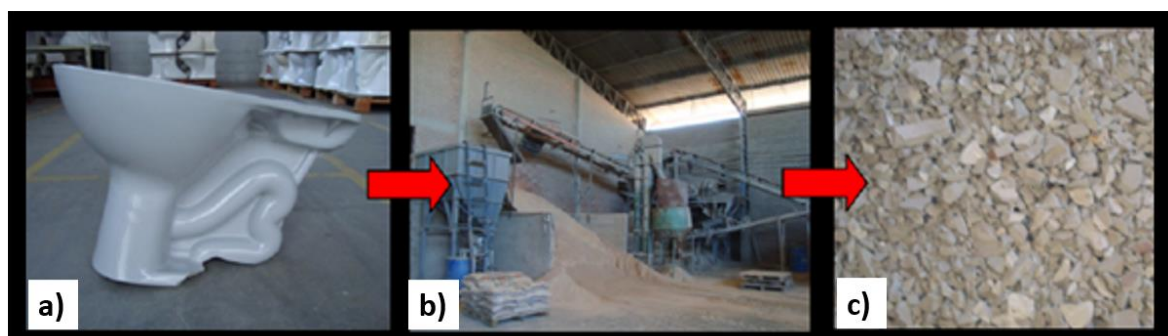
Figura 1 – Etapas de obtenção do pitcher a) Peça cerâmica com defeito; b) Britagem da louça; c) Pitcher
