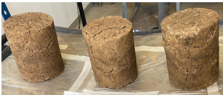
Figura 4.31 - Corpos de prova após secagem de 42h ao ar, no primeiro ciclo do ensaio de durabilidade.
