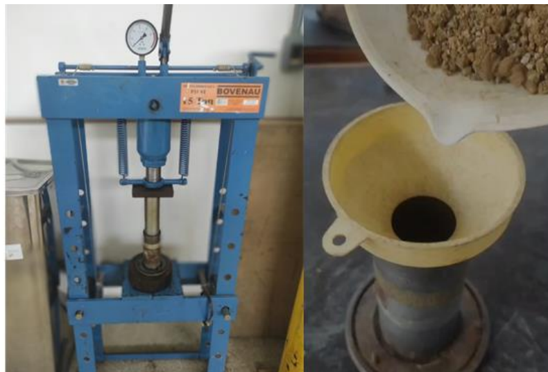
Figura 3.9 - Prensa hidráulica e moldes metálicos utilizados para moldagem dos corpos de prova.
