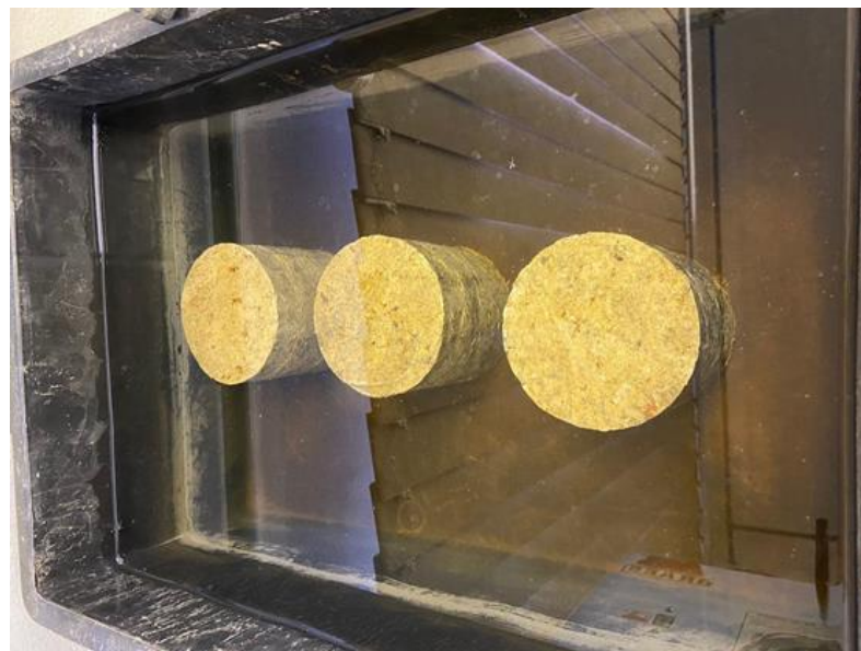
Figura 4.28 - Corpos de prova de solo tratado com 3% de LS, após imersão de 5h no primeiro ciclo do ensaio de durabilidade.
