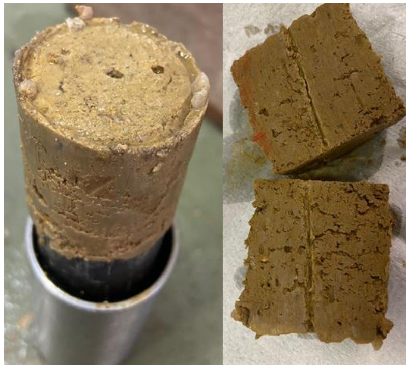
Figura 4.24 - CP tratado com 3%LS \gamma = 16,8\text{kN/m}^3 e curado por 28 dias, após Pinhole Test.
