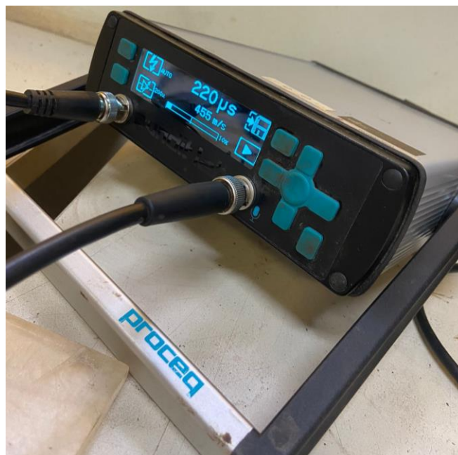
Figura 4.36 - Leitura do tempo t_p correspondente à amostra de solo tratada com 3% de LS.
