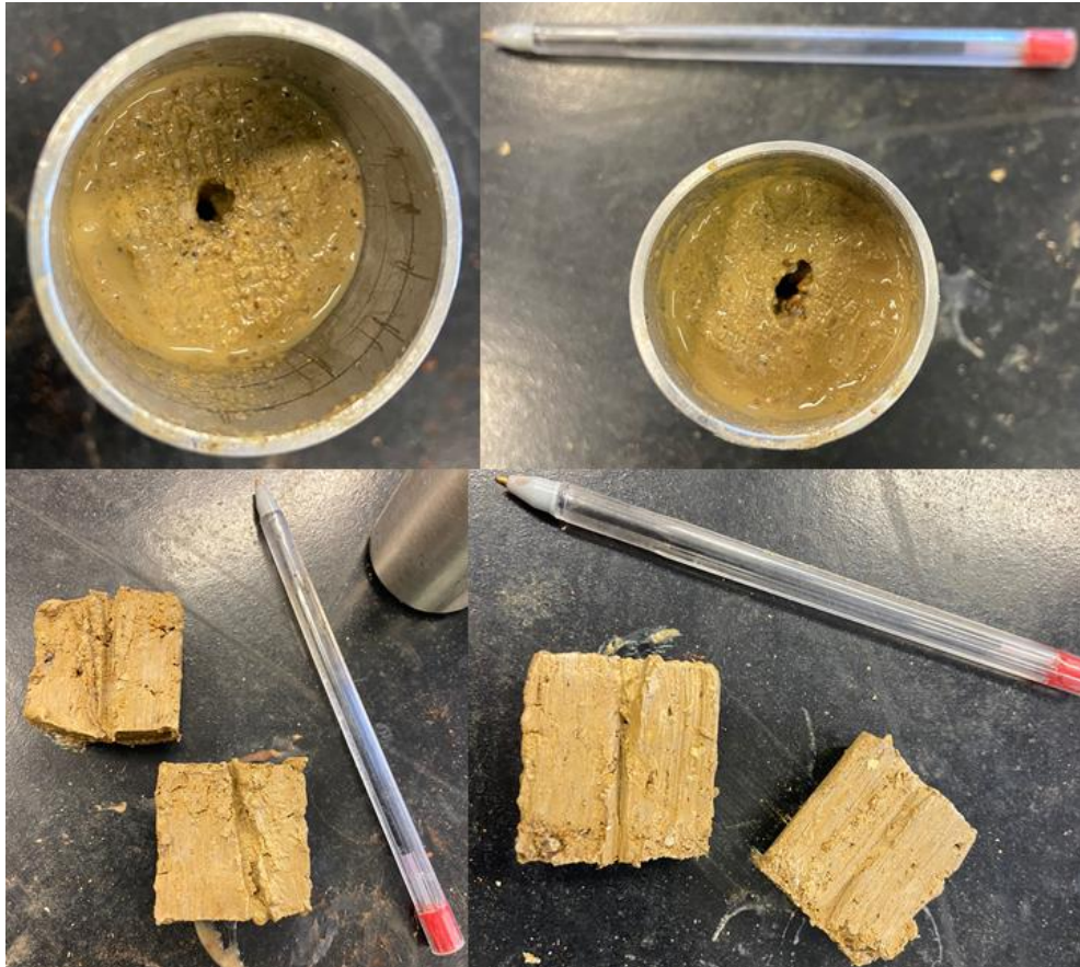
Figura 4.23 - Corpos de prova de solo natural \gamma = 16,8\text{kN/m}^3 , após Pinhole Test.
