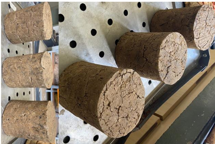
Figura 4.29 - Corpos de prova após secagem de 42h em estufa a 71°C, no primeiro ciclo do ensaio de durabilidade.
