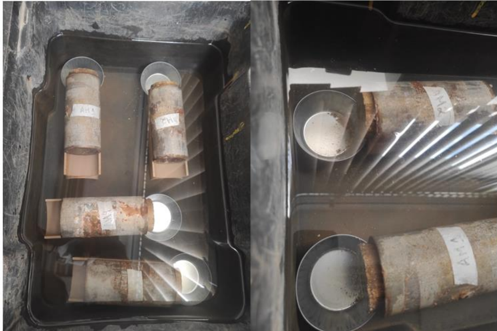
Figura 4.9 - Início do ensaio de perda de massa por imersão da Metodologia MCT, solo dispersivo.
