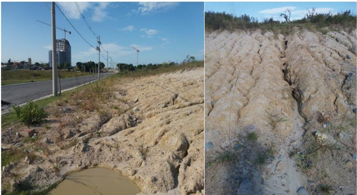
Figura 3.7 - Local de amostragem do solo, apresentando visualmente comportamento dispersivo: ravinamento e água turva acumulada.
