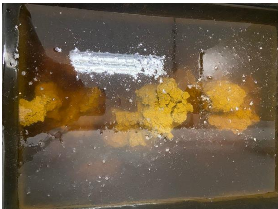
Figura 4.30 - Corpos de prova durante a imersão, no segundo ciclo do ensaio de durabilidade.
