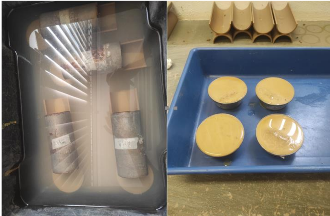
Figura 4.10 - Final do ensaio de perda de massa por imersão da Metodologia MCT, solo dispersivo.
