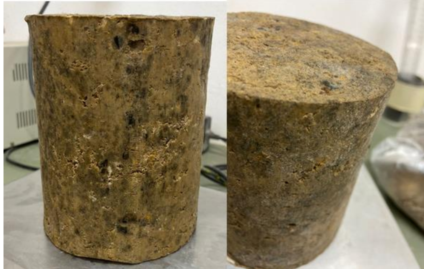
Figura 4.27 - Corpo de prova de solo tratado com 3% de LS, compactado com \gamma_d = 16,8\text{kN/m}^3 e curado por 28 dias.
