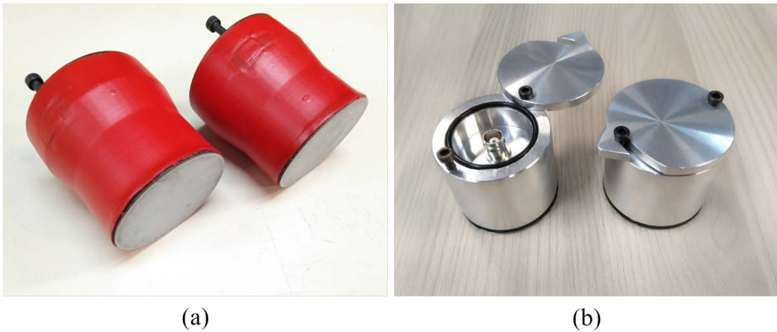
Figura 12 – Conjunto completo do transdutor. (a) Invólucro de proteção em ABS. (b) Invólucro de proteção em alumínio.
