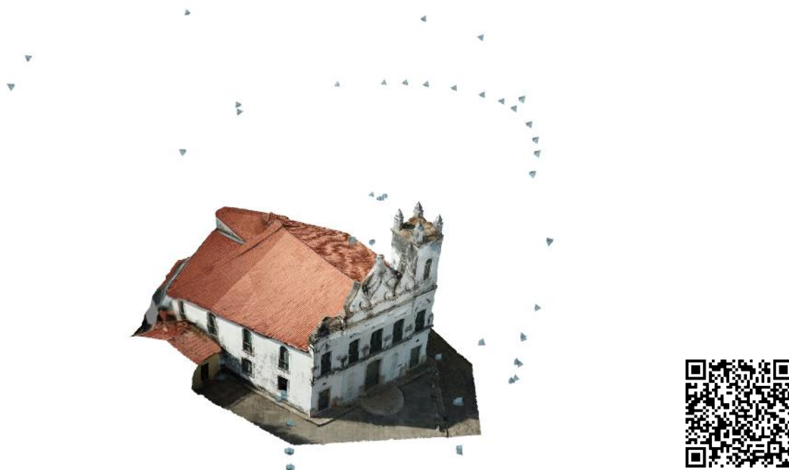
Figura 48 – Pontos de registros para a digitalização da Igreja do Desterro
