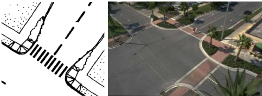
Figura 11: extensão de calçada (FEDERAL HIGHWAY ADMINISTRATION, 2002)
