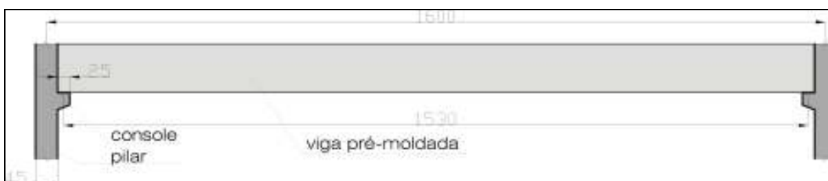
Figura 4: vista lateral da viga analisada
