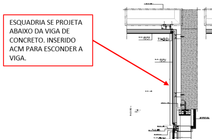
Figura 59 – Alteração de acabamento na fachada (Trecho 05)
