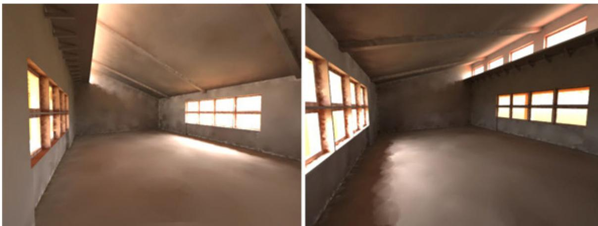
Figura 24: visualização do ambiente simulado, com renderização gerada pelo Desktop Radiance
