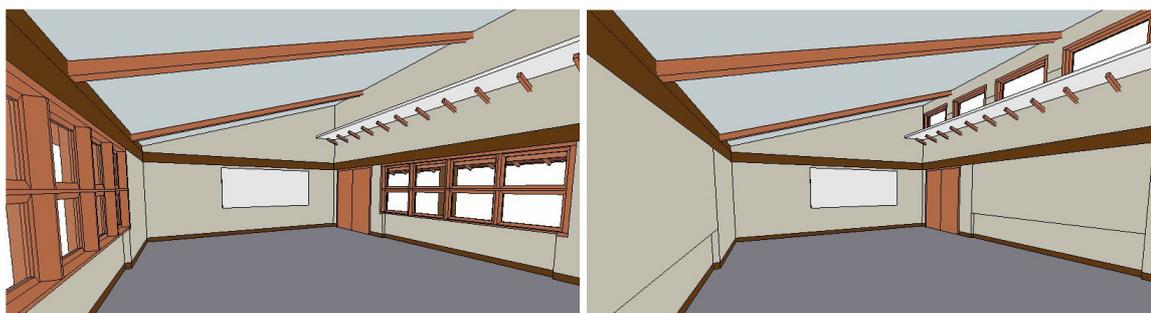
Figura 25: modelos gerados no Ecotect para estudo da prateleira de luz, caso 1 (esquerda) e caso 2 (direita)
