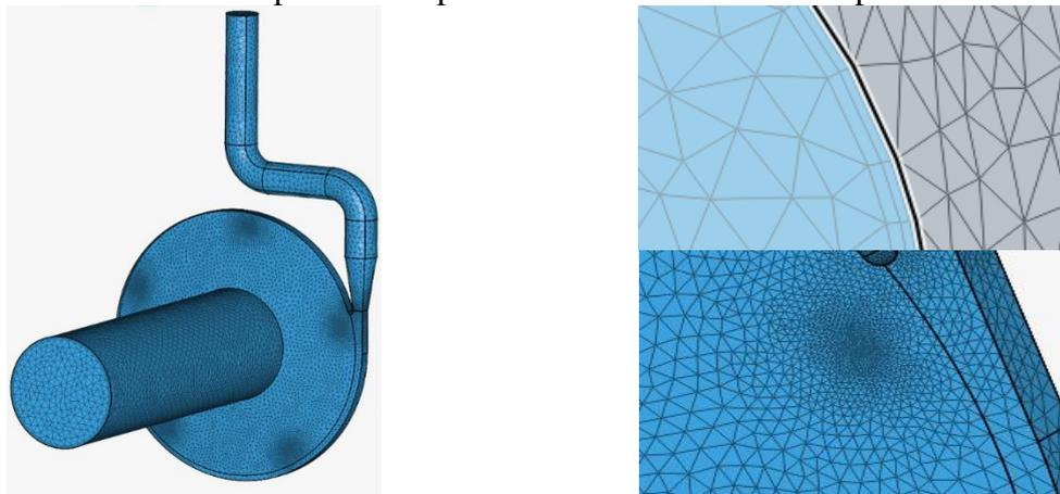
Ressalta-se que nas condições próximas a parede e em zonas críticas de recirculação como as extremidades das pás dos rotores exigem aumento da densidade de malha para que o modelo de turbulência  $k-\omega$  SST capture o efeito da camada limite. Foi utilizada função de parede para a camada limite com um valor de  $y^+$  da ordem de 100.
