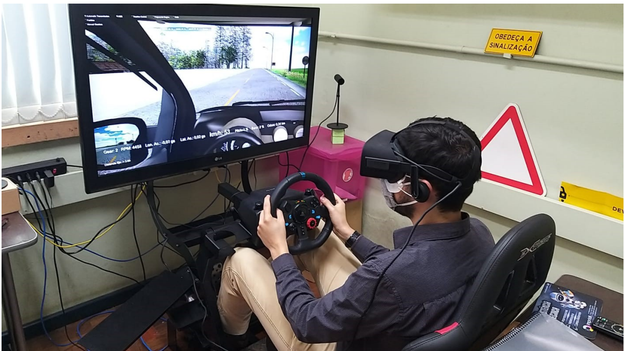
Figura 2: Simulador de Direção Veicular do Laboratório de Sistemas de Transportes
