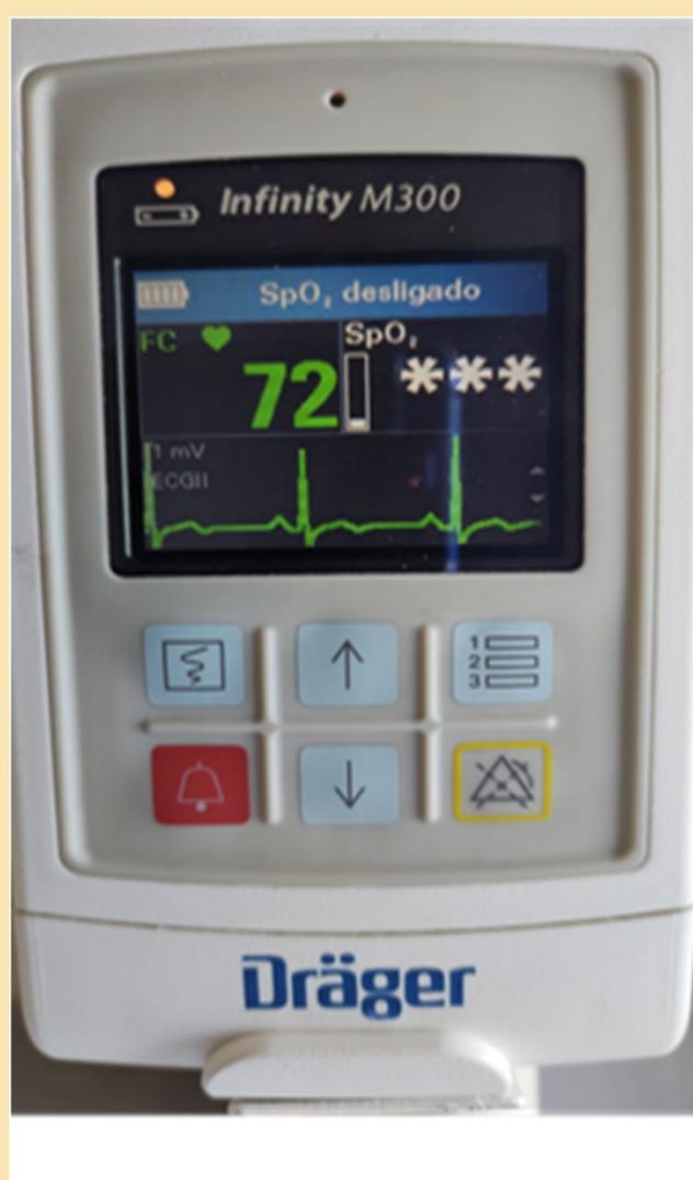
Figura 2 – Aparelho de telemetria
