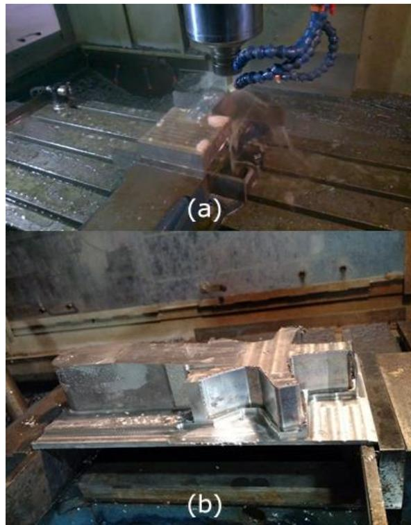
Figura 36 - Foto do macho de corte artesanal fabricado em aço inox.
