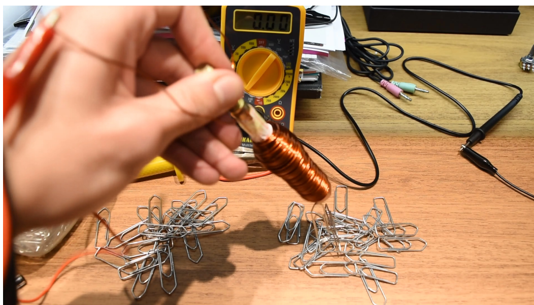
Figura 11 - Eletroímã de 400 voltas, sem limitação de corrente elétrica, coletando prendedores de papel
