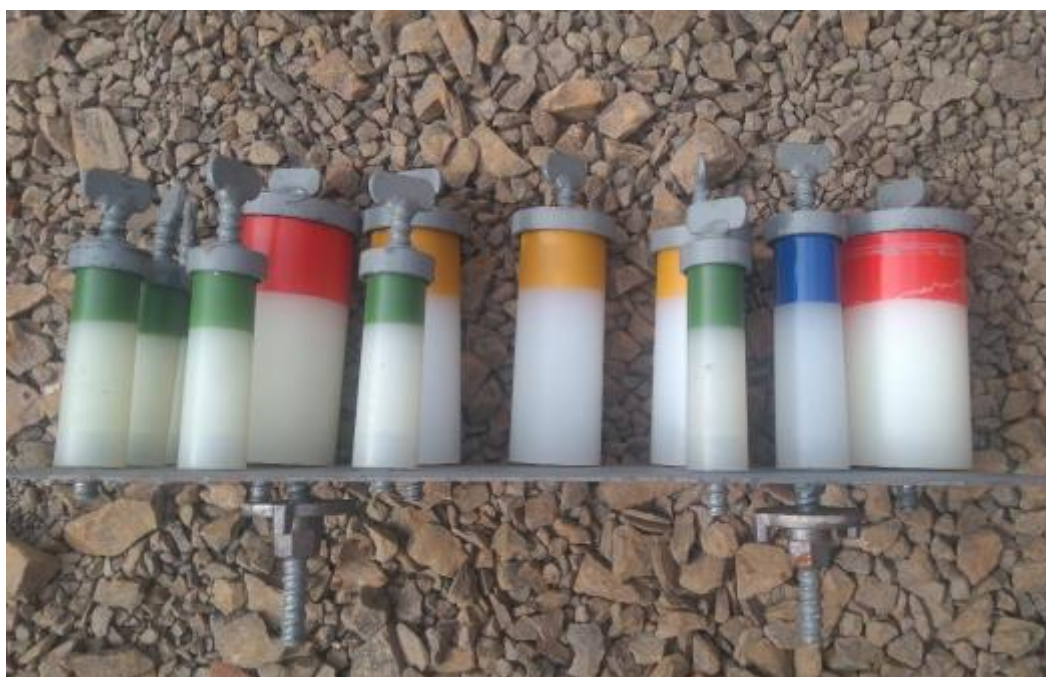
Figura 41 – Gabarito com passantes de nylon
