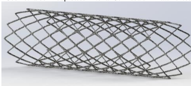
Figura 3.2 – Geometria de Endoprótese Arterial Utilizada em Tratamentos de Estenose
