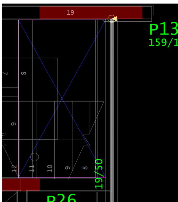
Figura 35- Fechamento de bordo para piso auxiliar. (Fonte: Autor, 2021)
