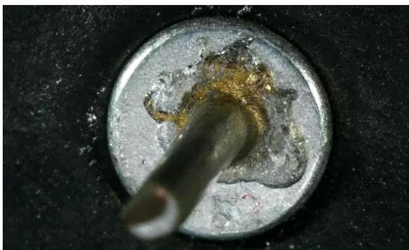
Tal fenômeno da expulsão ou salpico de solda pode ser observado frequentemente nos processos de soldagem por resistência elétrica. A projeção do metal fundido é altamente indesejada e pode resultar na redução da força que suporta o componente final (conjunto soldado), além de interferir nos equipamentos adjacentes devido à sujeira e contaminação
