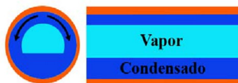
Figura 5: Seção transversal e longitudinal do perfil de condensação em película (Fonte: OLIVEIRA, 2004)
