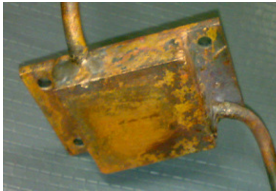
Figura 9: Bloco de cobre unido com a tubulação da serpentina
