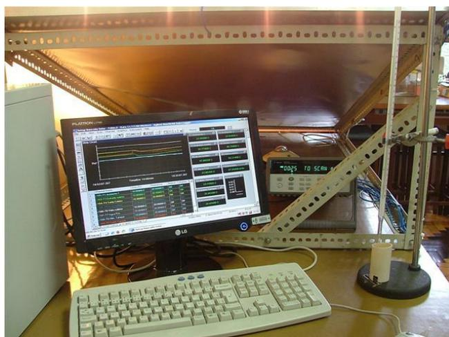
Figura 4.4 – Equipamentos de medição da bancada
