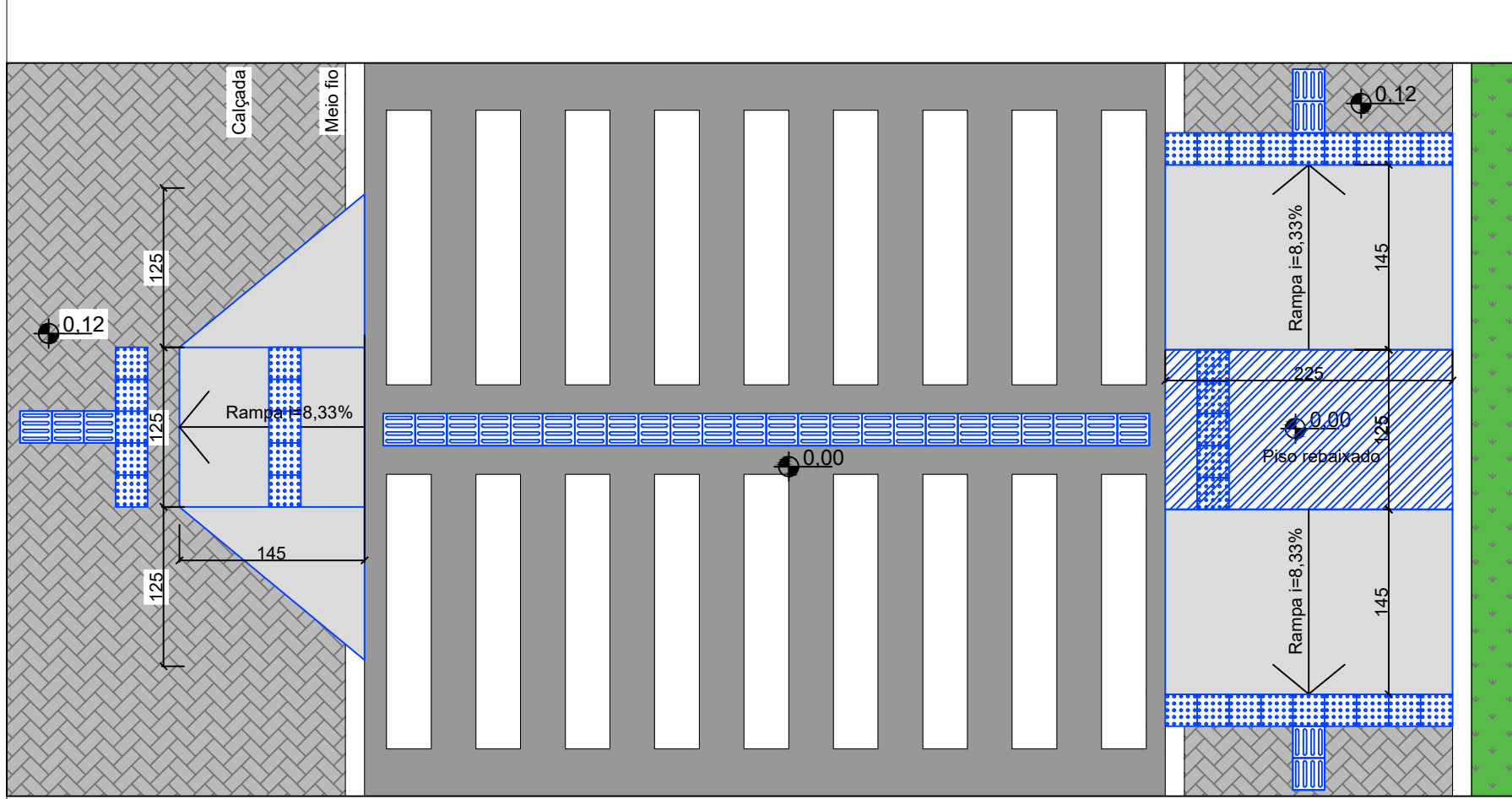
Det. 10 - Rebaixamento de Calçada Esc. 1/50
