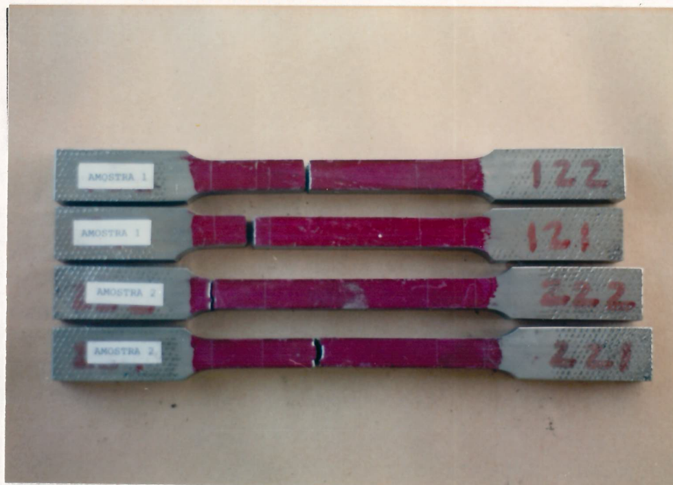
FOTO 11: Corpos de prova de tração. Note a ausência de estricção.
