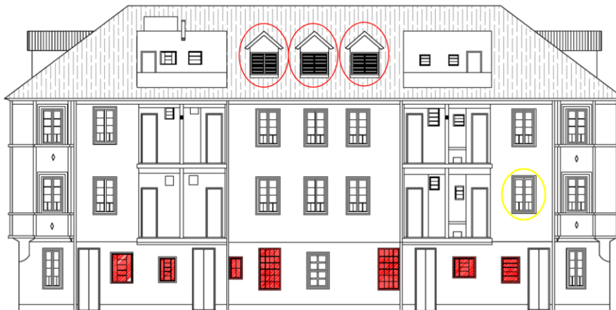
Figura 36: Fachada sudeste atual do edifício São Carlos com as janelas que serão retiradas (hachuradas em vermelho)
