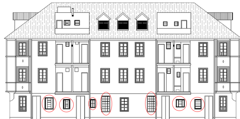
Figura 21: Fachada sudeste atual do edifício São Carlos (janelas fora do padrão circuladas em vermelho)
