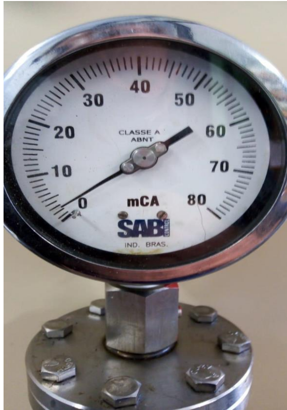
Figura 3: Manômetro com tubo Bourdon SABI, escala de 0 -80 mca. Fonte: Elaborado pela autora.
