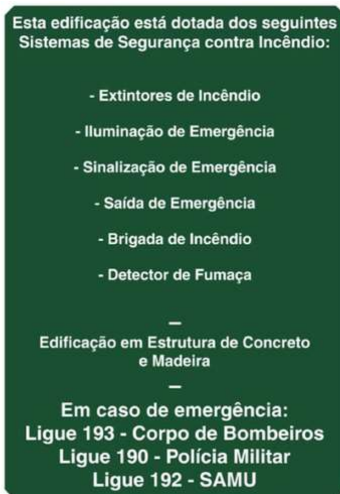
Figura 27: Placa identificando os Sistemas de Segurança contra Incêndio presentes na edificação.
