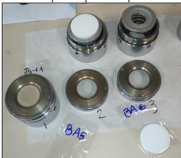
Figura 3 Amostras na forma de pastilhas prensadas e porta amostras RIX 2000
