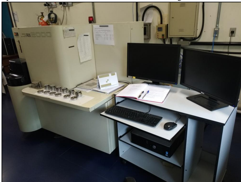
Figura 4 Espectrômetro de Raios X RIX 2000 da marca Rigaku do Laboratório de Geoquímica
