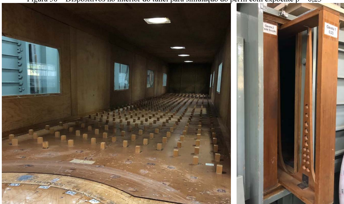
Figura 50 – Dispositivos no interior do túnel para simulação do perfil com expoente p = 0,23
