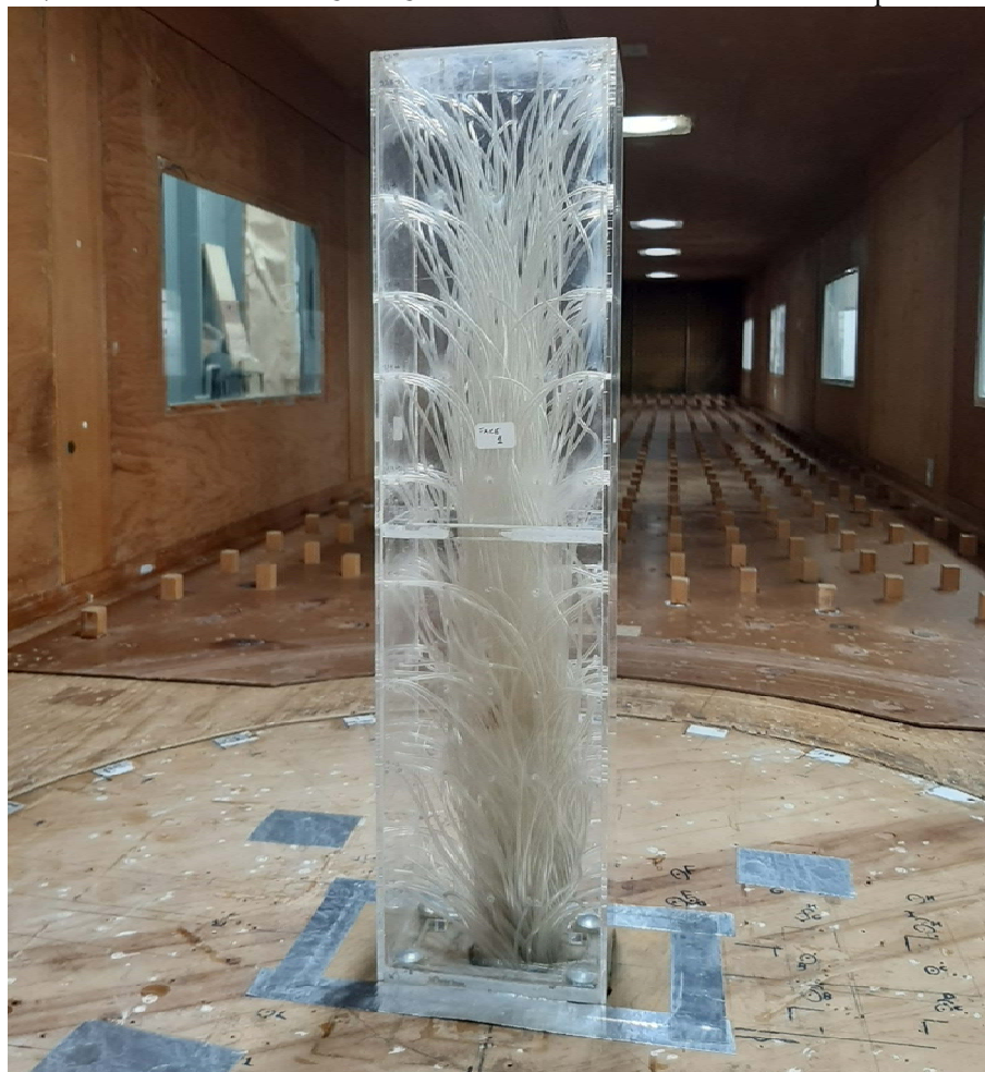
Figura 47 – Modelo reduzido do CAARC no interior do túnel de vento Prof. Joaquim Blessmann
