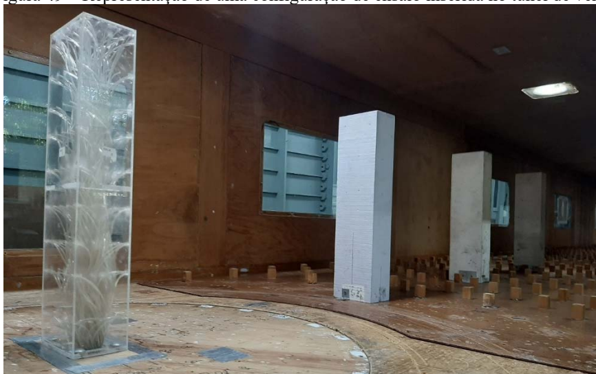
Figura 49 – Representação de uma configuração de ensaio inserida no túnel de vento
