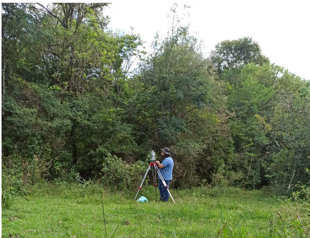
Foto 11 – Leonardo realizando estacionamento da estação total
