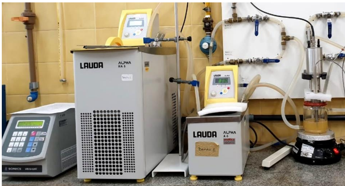
Figura 12 - Aparato experimental de aplicação do ultrassom.
