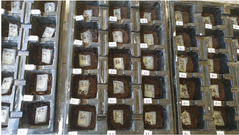
Figura 20 - Filmes submetidos à análise de biodegradabilidade.
