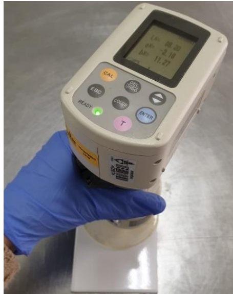
Figura 18 - Medição dos parâmetros de cor dos filmes com colorímetro.
