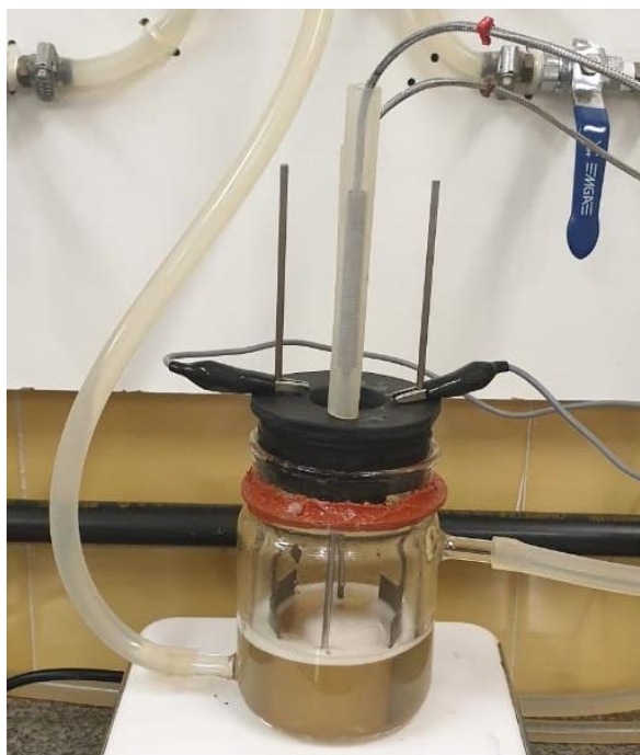
Figura 11 - Célula ôhmica com eletrodos e termopares.
