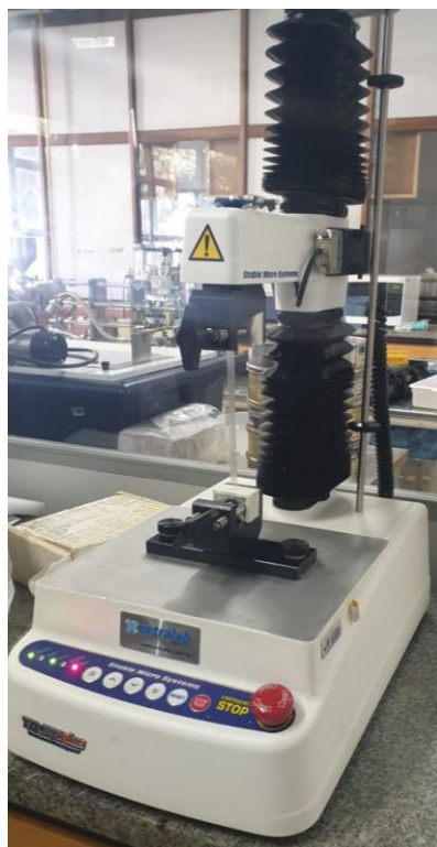
Figura 17 - Análise das propriedades mecânicas realizada em texturômetro.
