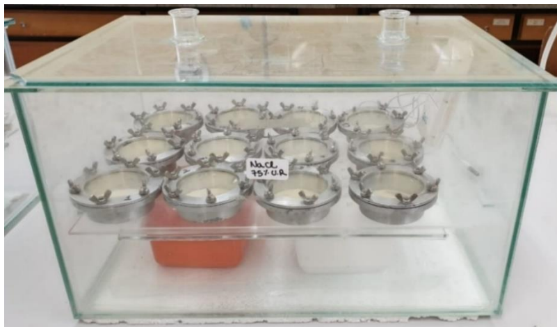
Figura 16 - Análise de permeabilidade em cuba contendo solução saturada de NaCl.
