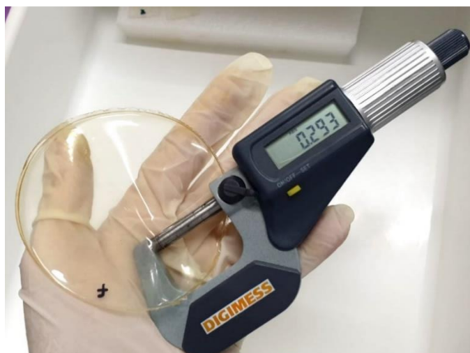
Figura 15 - Medição da espessura dos filmes com micrômetro digital.
