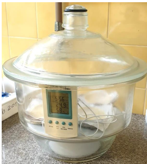
Figura 9 - Filmes armazenados em dessecador contendo solução saturada de NaBr.
