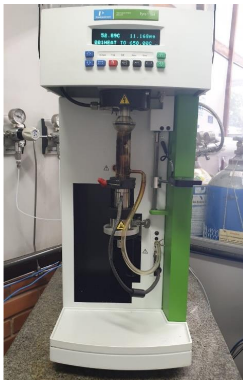
Figura 19 - Análise de estabilidade térmica em analisador termogravimétrico.
