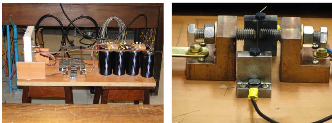
Figura 4.18 – Sistema de estampagem eletromagnética nos testes do interruptor principal.
