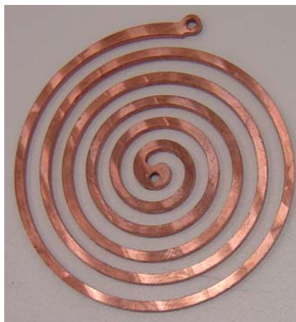
Figura 4.15 – Bobina espiral plana usinada em cobre eletrolítico.
