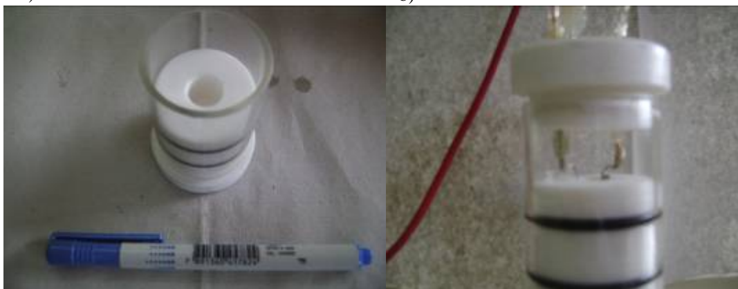
Fig. 3.5 Mini-célula eletroquímica utilizada em experimentos em que o eletrólito foi LI a) Corpo da mini-célula mostrando o orifício em que se colocou o eletrólito e b) Disposição do eletrodo de referência e contra eletrodo dentro do orifício.
