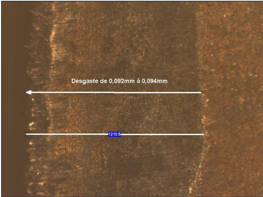
Figura 4.4. Desgaste do teste 2 (VTA, 3%) com 1000 metros de barra processada.
