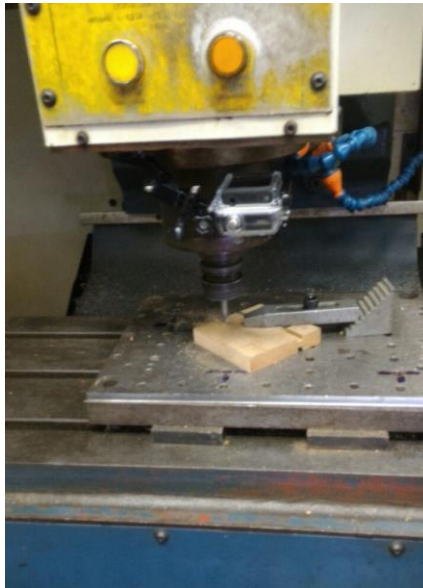
Figura 25 – Usinagem de um corpo de prova no centro de usinagem Romi Discovery 308.
