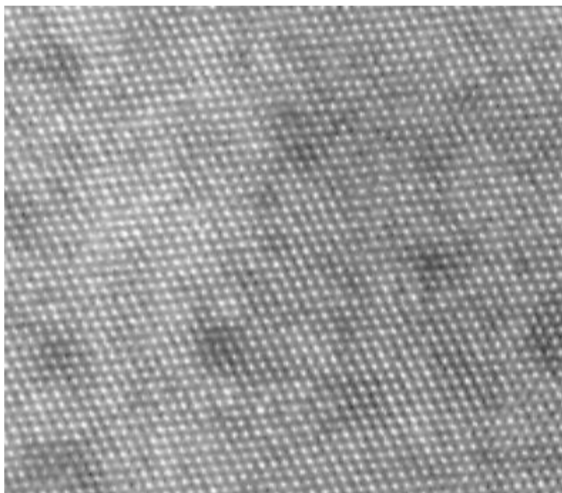
Figura 3.13 Micrografia de uma amostra de GaAs mostrando a contribuição dos planos cristalinos (110).
