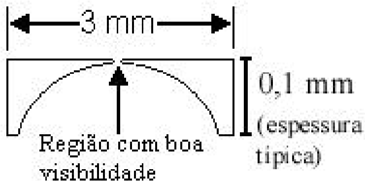
Figura 3.1 Figura em corte mostrando esquematicamente como se parece uma amostra auto portante para análise por microscopia eletrônica de transmissão
