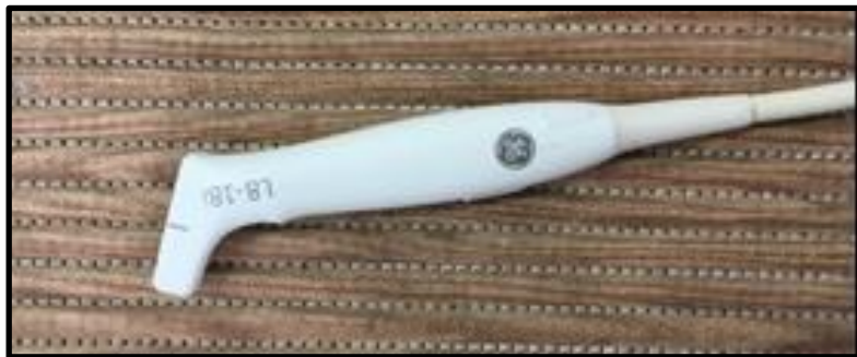
Figura 8 – Transdutor linear L8-18i-RS utilizado para realizar o estudo ultrassonográfico do diâmetro do nervo óptico em cães.
