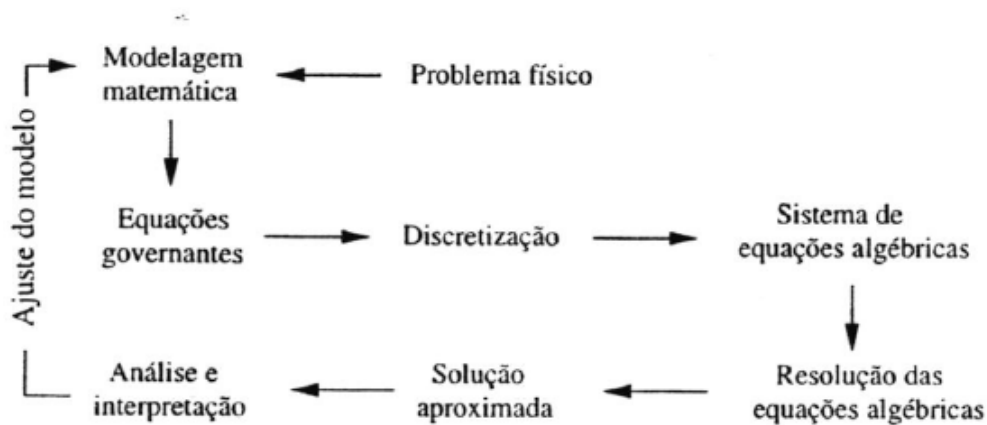
Figura 4.1: Etapas para a obtenção da solução numérica de um problema de fluidos. Fonte:[23]
