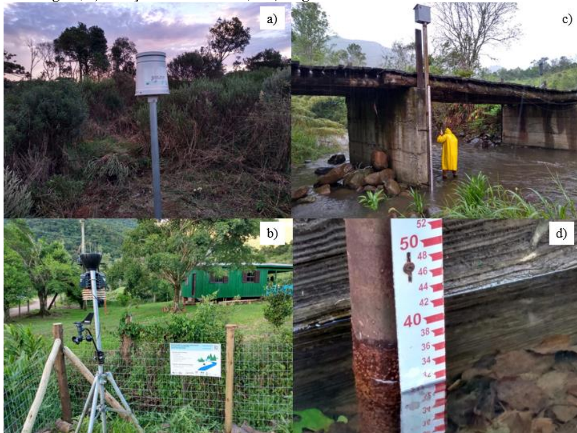
Figura 7 - Equipamentos de monitoramento hidrometeorológicos: a) Pluviógrafo; b) Estação meteorológica; c) Estação fluviométrica; e d) Régua linimétrica.
