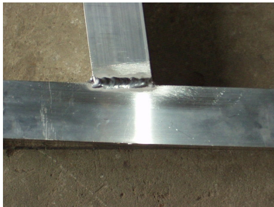
Fig. 6.1 - Detalhe da soldagem de uma junção do quadro.
