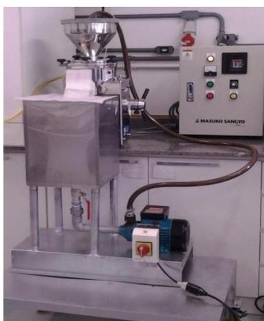
Figura 1. Esquema de funcionamento e montagem do moinho Super Masscolloider MKCA6-2 Masuko®.
